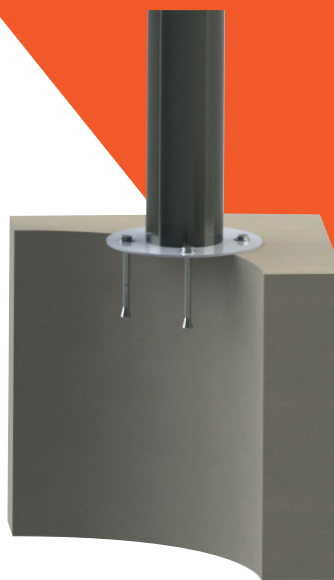
Anclaje con perno de rosca interna de 8x80mm. para suelo de hormigón.
